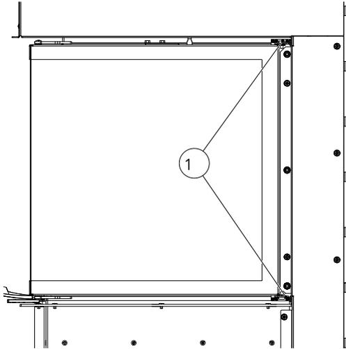
Abb. 65: Türrahmenlager
