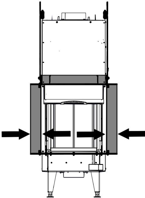
Abb. 43: Designrahmen ausrichten
