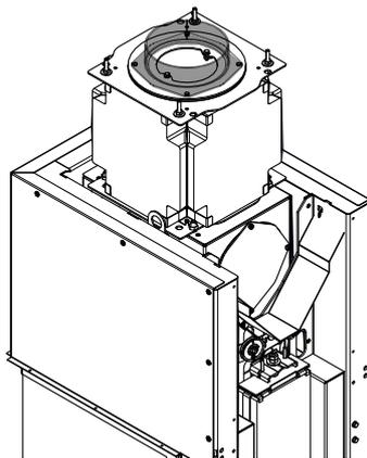
Abb. 30: Rauchrohrstützen montieren
