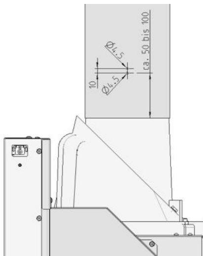
Abb. 52: Bohrschema-Rauchrohr
