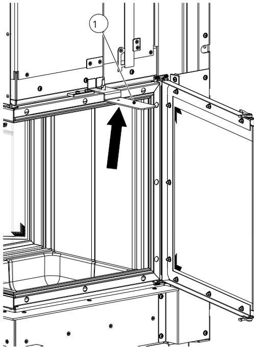
Abb. 78: Seilhalter einsetzen
