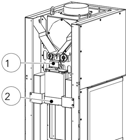
Abb. 5: Transportsicherungen entfernen
