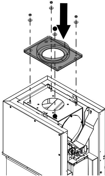
Abb. 27: Adapterplatte montieren
