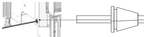
Abb. 61: Gummiverschluss einrasten
