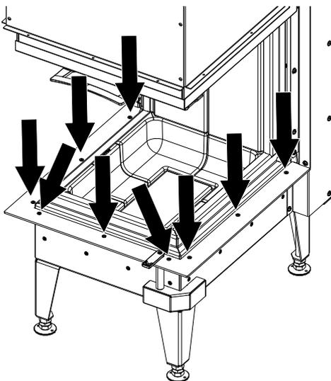
Abb. 34: Gewinde lösen
