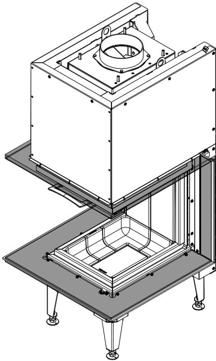
Abb. 35: Designrahmen montieren
