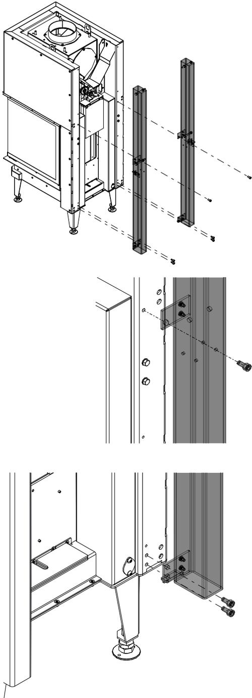
Abb. 49: Traggestell montieren
