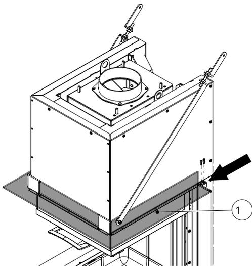
Abb. 41: Designrahmen oben montieren
