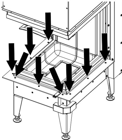
Abb. 37: Gewinde lösen
