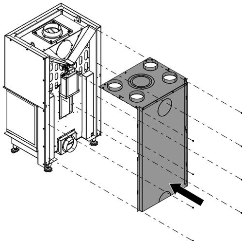
Abb. 32: KV-Mantel montieren
