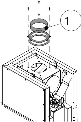
Abb. 28: Rauchrohrstützen demontieren
