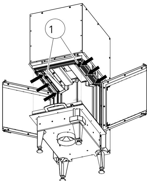
Abb. 77: Sekundärluftführung entfernen
