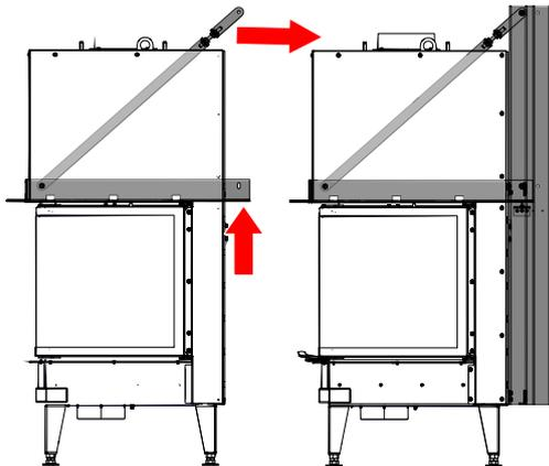
Abb. 48: Tragrahmen ausrichten
