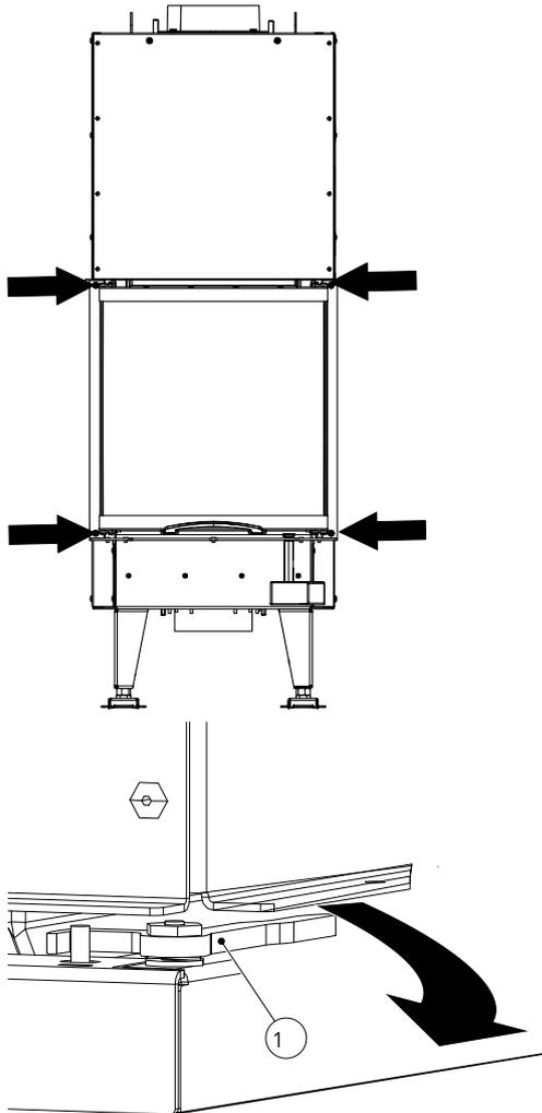
Abb. 72: Verriegelungshebel öffnen
