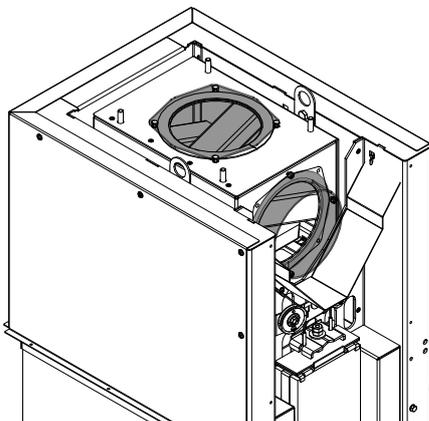
Abb. 25: Rauchrohranschluss umbauen
