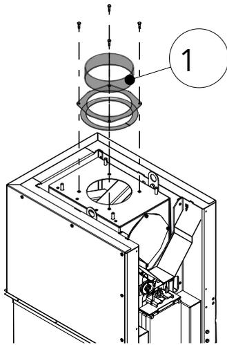
Abb. 26: Rauchrohrstützen demontieren
