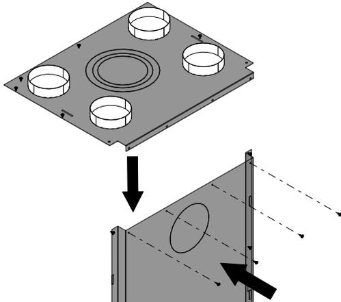
Abb. 31: KV-Mantel zusammenbauen
