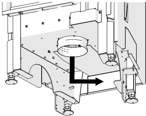
Der Verbrennungsluftstutzen muss immer angeschlossen werden, da ansonsten keine Verbrennungsluft in den Feuerraum geleitet wird.
