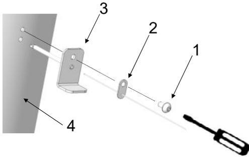
Abb. 53: Temperatur-Sensor montieren
