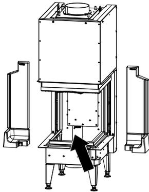
Abb. 2: Typenschild 48x 64x 75x Vuur Drie
