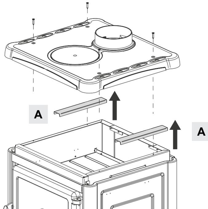
Almeno una volta all'anno è consigliabile eseguire una pulizia dei particolari A, o qualora sia necessario (problemi di mal funzionamento con scarsa resa). A pulizia eseguita gli stessi vanno riposizionati nelle loro sedi.
