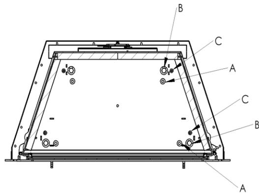
A: Löcher für die Befestigung der Einsatz im Verhältnis zur Unterlage.
