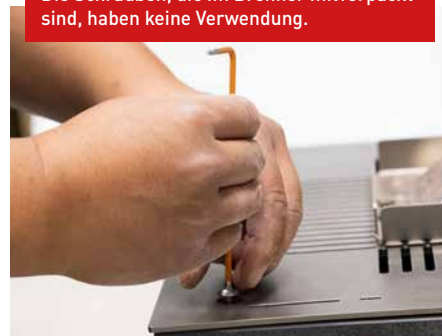
3. Den Brenner vorsichtig aus der Folie auspacken und mit den vier mitgelieferten Edelstahlschrauben M5 auf das Grundgestell montieren.
