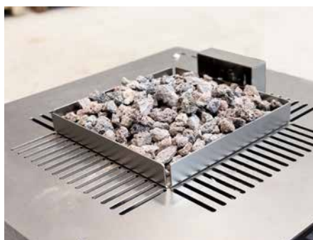
5. Verteilen Sie die Lavasteine in Form eines kleinen Hügels auf dem Brennerbett. Achten Sie darauf, dass keine kleinen Steinsplitter in den Brenner gelangen.
