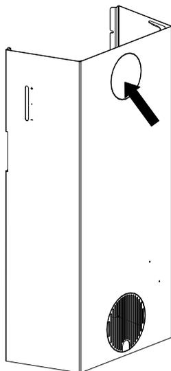
Abb. 9: Perforierten Ausschnitt entfernen
