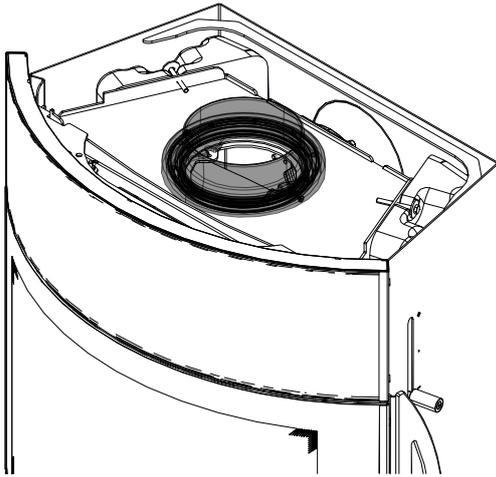
Abb. 36: Drehrauchrohrstützen montieren
