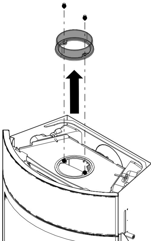
Abb. 39: Rauchrohrstutzen abmontieren
