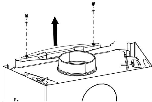
Abb. 30: Schrauben lösen
