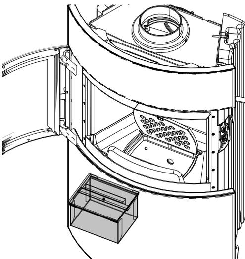
Abb. 68: Aschebox rausnehmen und entleeren
