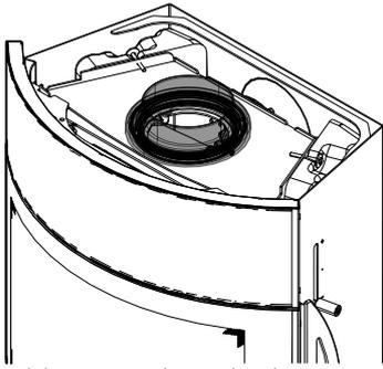
Abb. 46: Drehrauchrohrstützen montieren
