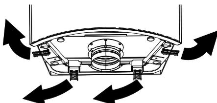
Abb. 7: Transportsicherung entfernen
