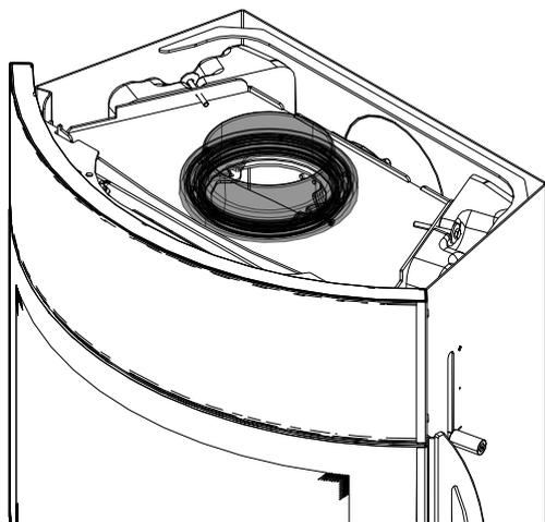
Abb. 40: Drehrauchrohrstutzen montieren
