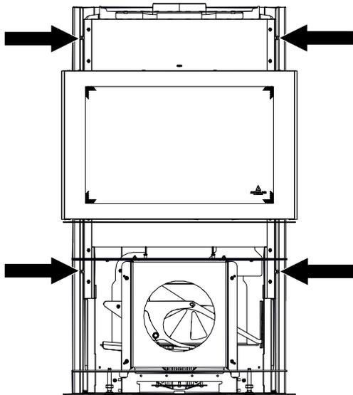
Abb. 72: Schrauben lösen
