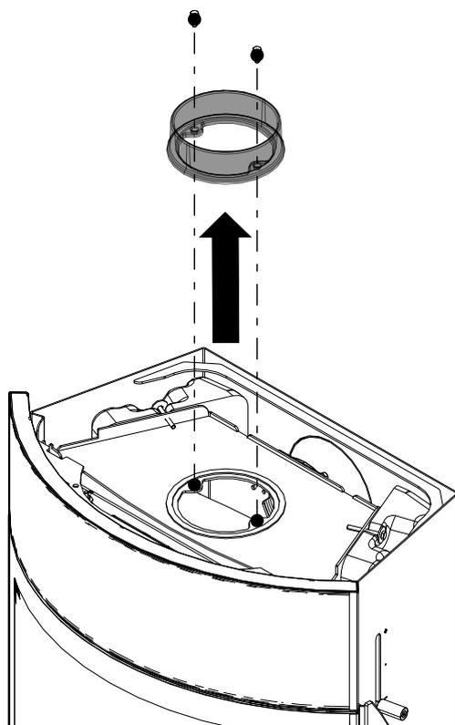
Abb. 35: Rauchrohrstutzen abmontieren
