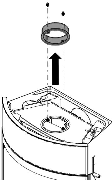
Abb. 45: Rauchrohrstutzen abmontieren
