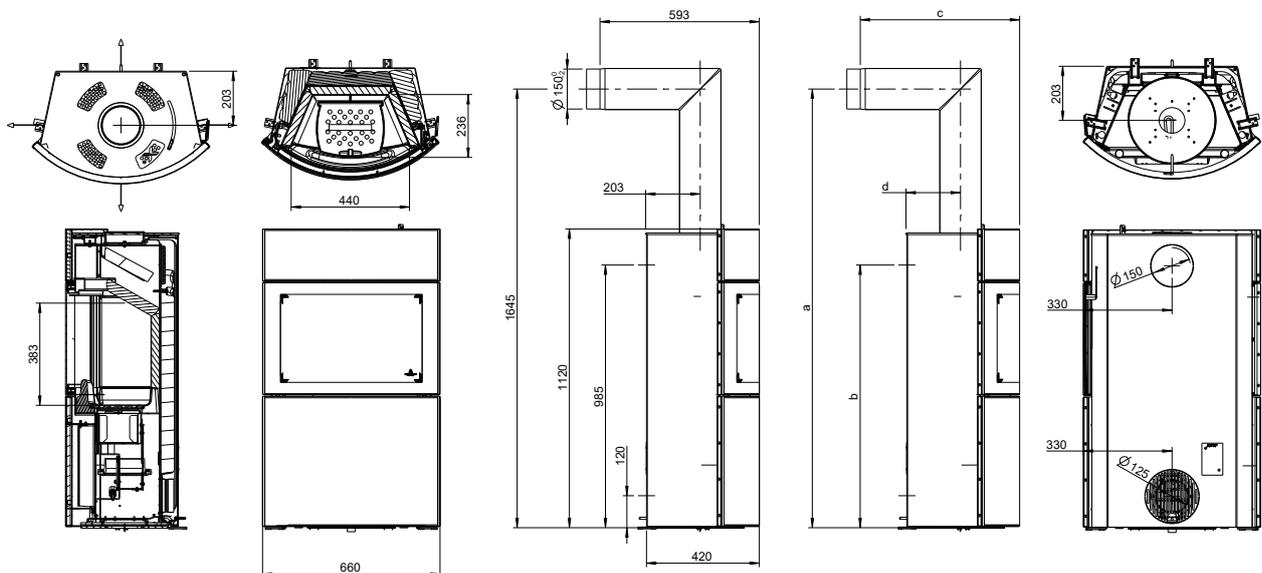
Abb. 2: Abmessungen Grundgerät
