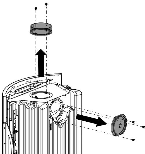
Abb. 10: Abdeckung und Rauchrohrstutzen demontieren
