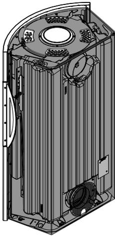
Abb. 13: Seitenverkleidung montieren
