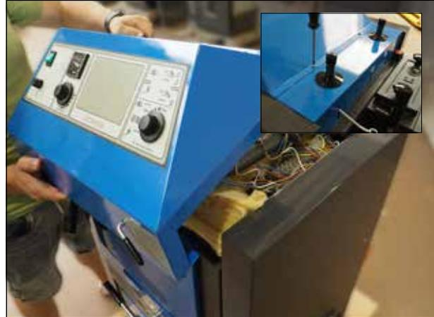
2. Wir öffnen die obere Kesseltür, schlagen die Stifte in den Scharnieren aus, damit wir die Tür demontieren können.
