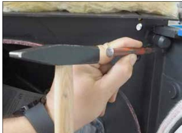
4. Wir entfernen die Seitenhaube des Kessels, um alle notwendigen Kabel (für den 2-poligen Stecker (R3 und R4), den TK-Sensor und den Belimo-Antrieb) durchziehen und anschließen zu können.
