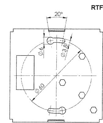
Die Konvektionsöffnungen müssen nach oben/unten ausgerichtet sein um eine Durchströmung mit Raumluft zu gewährleisten. (siehe Kennzeichnung Gehäuse Rückseite)
