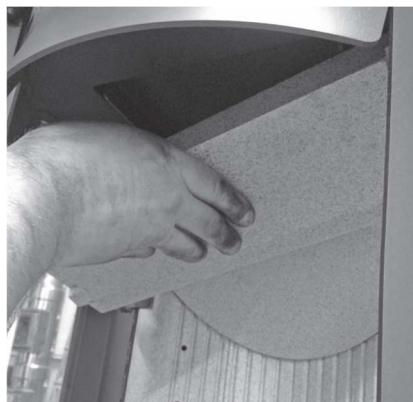
Heben Sie dann die hintere Zugumlenkung an und entfernen Sie auch diese aus dem Feuerraum.
