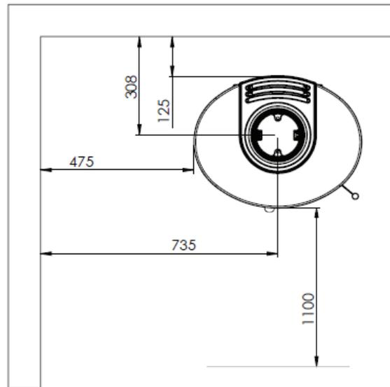
**TT23RG: Bei Anwendung von ISOLIERTEN Rohren\***
