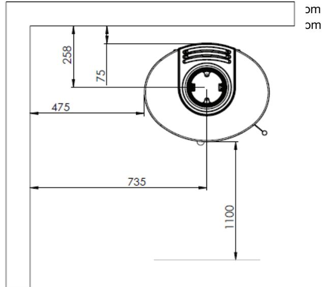
**TT23RGS: Bei Anwendung von UNISOLIERTEN Rohren\***
