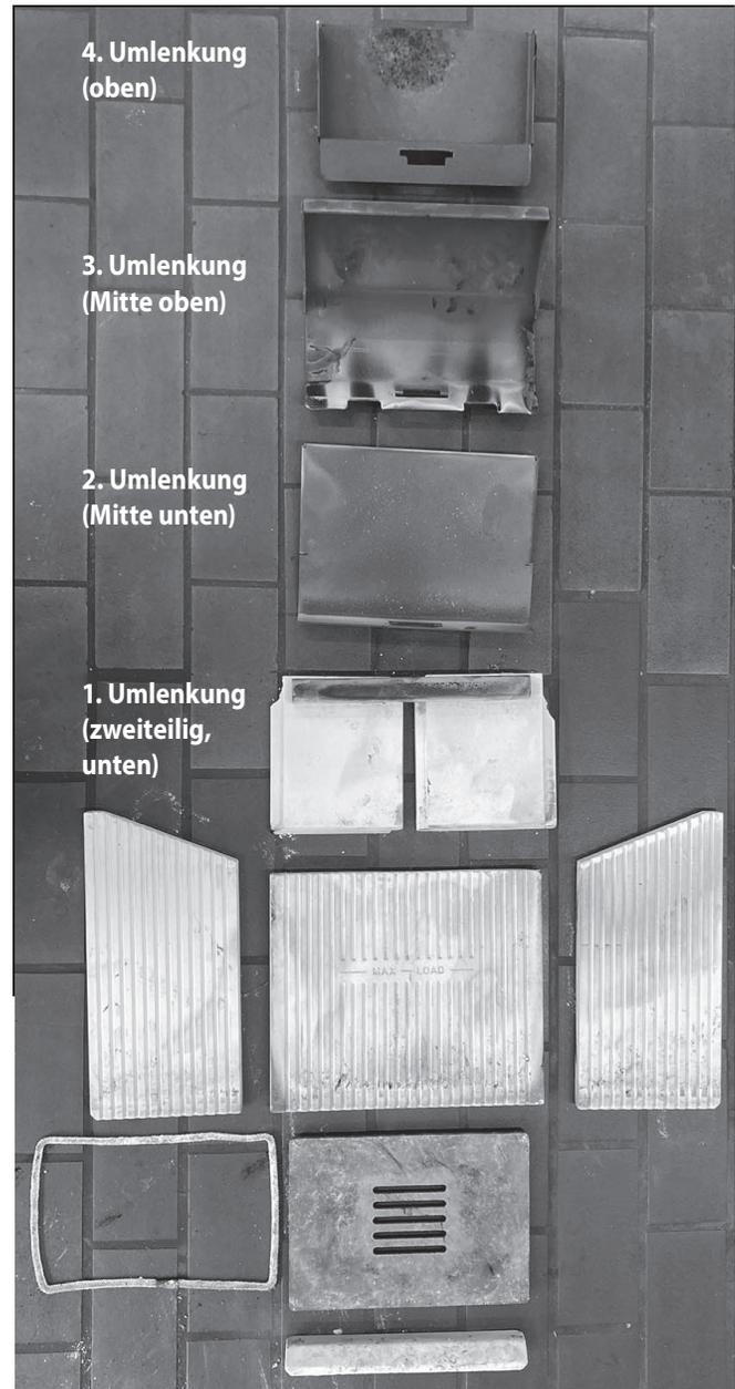
**i** An den Formelementen aus weißem Feuerbeton können im Heizbetrieb oberflächliche Risse entstehen. Diese Risse sind unbedenklich. Erst wenn der darunterliegende Metallkorpus freiliegt, muss ein Austausch erfolgen. Die **Feuerraumauskleidung (8)** unterliegt nicht der Werksgarantie.
