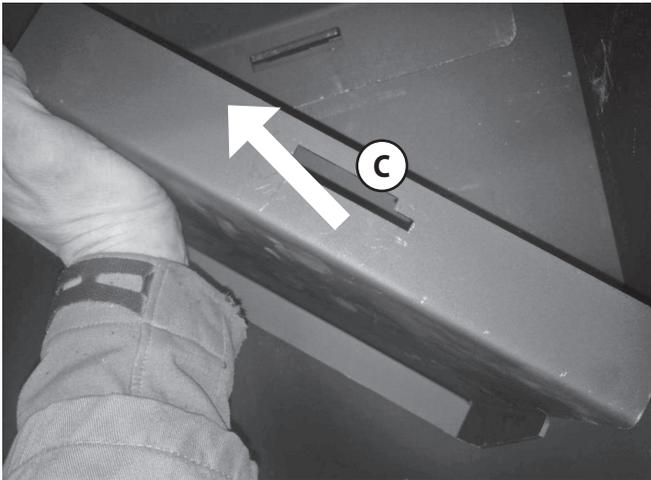
Darüber befindet sich die **3. Heizgasumlenkung**. Sie ist hinten am Gerätekorpus ebenfalls in einer Bajonethalterung eingehangen.
