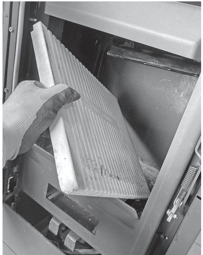
Über der **1. Heizgasumlenkung** aus Vermiculite befindet sich die **2. Heizgasumlenkung** (Stahl). Sie ist im vorderen Bereich in einer Bajonethalterung eingehangen.
