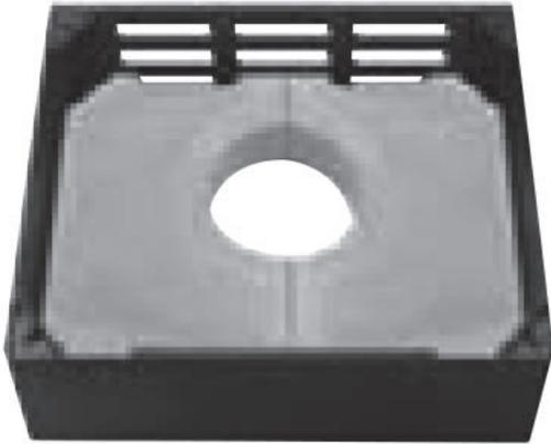
Die „E-Blok“ Erweiterungssegmente beinhalten einen Wärmespeicher aus Ofenbeton mit einer Dichte von  $2,9 \text{ kg/dm}^3$ . Dieser Wärmespeicher sorgt für eine gleichmäßige Wärmeabgabe. Während des Heizbetriebes wird Wärmeenergie in der Speicher­masse gespeichert. Nach dem Verlöschen des Feuers wird die so gespeicherte Wärmeenergie nach und nach gleichmäßig in den Aufstellungsraum abgegeben.
