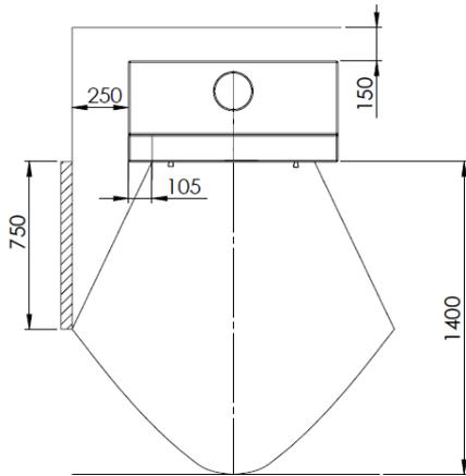
Achtung: Im schraffierten Bereich dürfen sich keine brennbaren Bauteile befinden.
