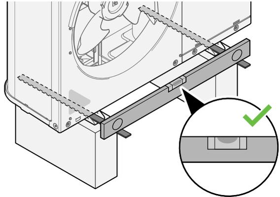
Verwenden Sie 4 Sätze mit M12-Ankerbolzen, Muttern und Unterlegscheiben. Lassen Sie mindestens 150 mm Freiraum unter dem Gerät. Stellen Sie zusätzlich sicher, dass das Gerät mindestens 100 mm über der maximal zu erwartenden Schneehöhe positioniert ist.
