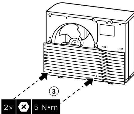
Installieren Sie den oberen Teil des Auslassgitters
