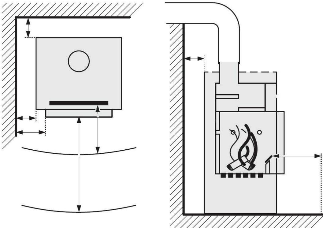
Wenn eine Feuerstätte ohne Abstand zu brennbaren / temperaturempfindlichen Materialien aufgestellt werden kann, ist dies im technischen Datenblatt und auf dem Typenschild vermerkt.
