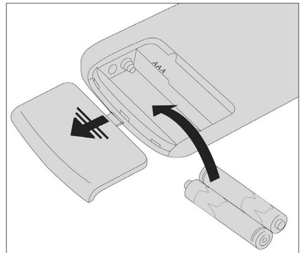
**WENN DIE FERNBEDIENUNG AUFGRUND DER ABWESENHEIT VON BATTERIEN AUSGESCHALTET IST, IST ES MÖGLICH, DEN OFEN ÜBER DAS BEDIENFELD IM OBEREN TEIL DES OFENS ZU STEUERN. BEIM AUSTAUSCHEN DER BATTERIEN IST DIE POLARITÄT ENTSPRECHEND DER SYMBOLE IM BATTERIEFACH DER FERNBEDIENUNG ZU BEACHTEN.**
