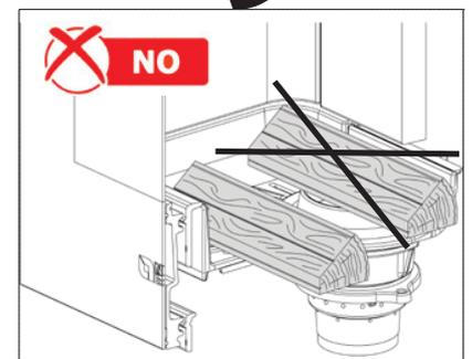
Wenn zu viel Holz nachgeladen wird, erscheint auf dem Display „UEBERLASTUNG“ und das Gerät ändert automatisch die Verbrennungsparameter, um die Sicherheit zu gewährleisten.
