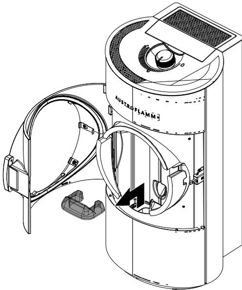
Abb. 27: Keramik-Stein entfernen
