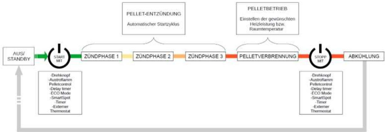
Abb. 17: Funktionsdiagramm
