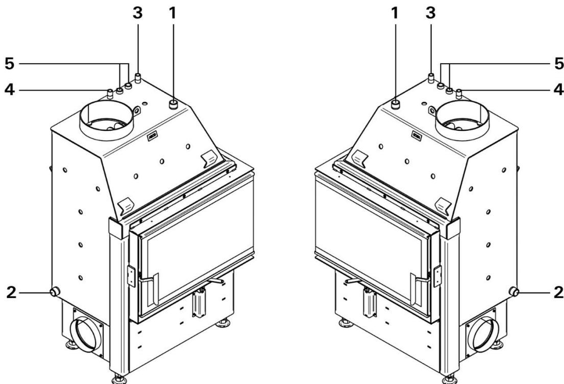
1. Wasserwärmetauscher – Vorlauf des erwärmten Wassers ins System, AG 1"
