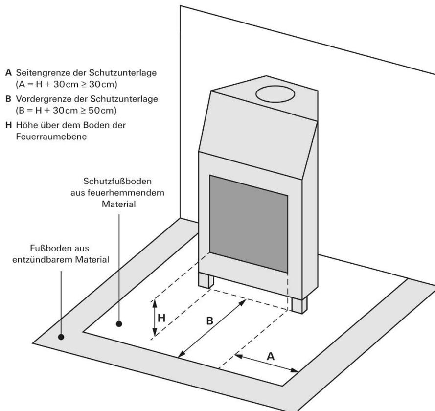
Die Skizze stellt eine mögliche Aufstellsituation mit Bodenplatte dar. Sie ist nur beispielhaft.
