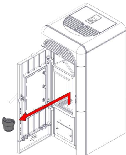
2) Die Brennerschale entfernen, reinigen und in einen NICHT brennbaren Behälter entleeren
