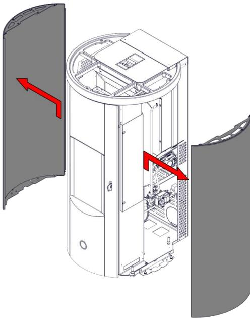
**3) Die ineinandergreifenden Seitenwände demontieren**
