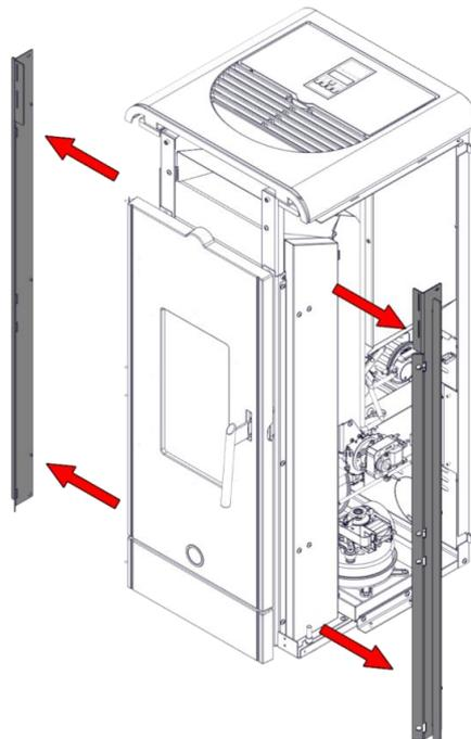
**5) Die Metallstützen demontieren**
