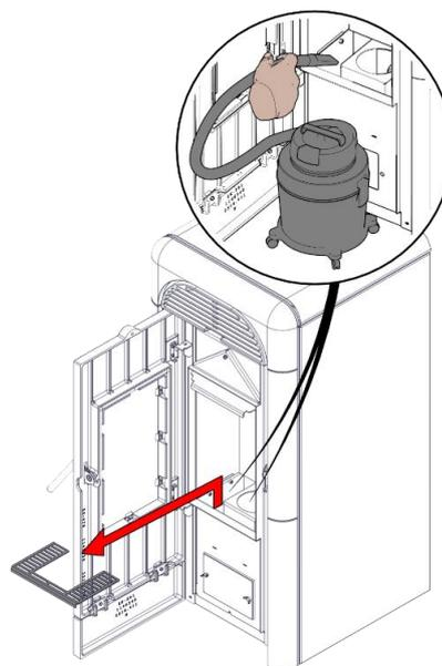
3) Das Schutzgitter entfernen und die Asche absaugen
