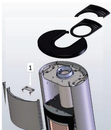
1. Heben Sie die Top-Platte an. Anschließend wird die Halterung Nr. 1 abmontiert. Die Frontplatte wird von den gelben Montagekegeln nach oben freigehoben – bewegen Sie die Frontplatte nach links und ziehen Sie sie dann auf der rechten Seite frei.
