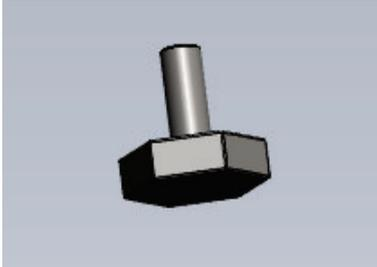
Die vier sechseckigen Stellfüße werden in die vier Gewindebohrungen montiert, die sich in der Bodenplatte befinden. Siehe die weißen Pfeile. Die Stellfüße werden mit den Fingern oder einem 25-mm-Gabelschlüssel justiert, so dass zwischen der Bodenplatte und dem Boden ein Abstand von etwa 8 mm besteht, je nach Wahl der Bodenplatte.
