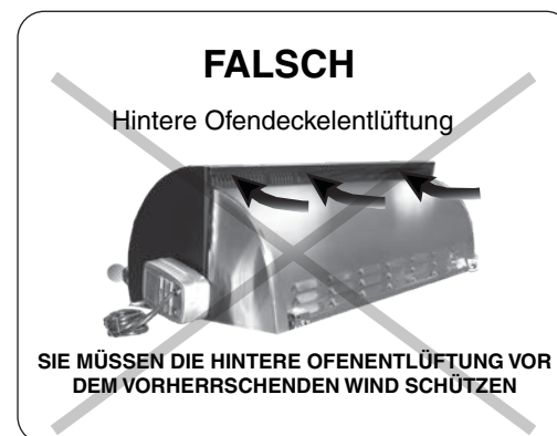
Abb. 11-4 Richtung des Luftstroms - FALSCH
