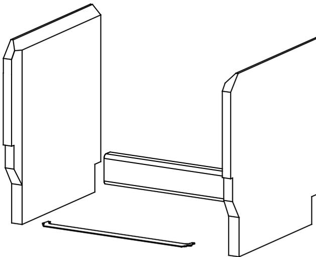
Die Zeichnung zeigt, wie sich die Brennraumauskleidung zusammensetzt. Sie besteht aus einem U-Profil, der linken und rechten Brennraumauskleidung sowie einem Sicherheitsprofil. Diese Brennraumauskleidung können Sie als Ersatzteil im Set bei uns nachbestellen.
