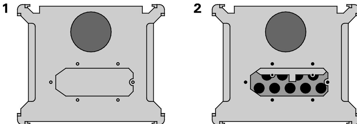
Sollte die Reinigung von oben nicht möglich sein, kann der Frontstein über dem Brennraum abgenommen und die darunter liegende Revisionsklappe durch Lösen der Schrauben geöffnet werden. Durch diese Öffnung erreichen Sie ebenfalls die Wärmetauscher-Rohre. Zusätzlich gelangen Sie über das Innere des Brennraumes an die hinteren Rohre des Wärmetauschers.
