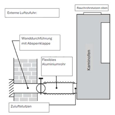
Bei externer Luftzufuhr achten Sie auf die ordnungsgemäße Verbindung der Rohre!
