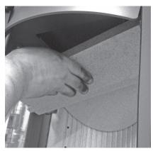
Heben Sie dann die hintere Zugumlenkung an und entfernen Sie auch diese aus dem Feuerraum.
