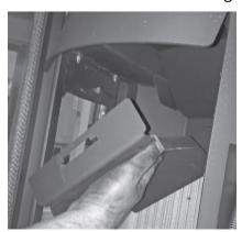
Schieben Sie die hintere Zugumlenkung vorsichtig nach oben und entfernen Sie diese aus der Steckvorrichtung.
