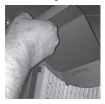
Schieben Sie schließlich die rechte Stahl-Zugumlenkung leicht nach oben und ziehen Sie diese dann nach hinten aus der Steckvorrichtung.
