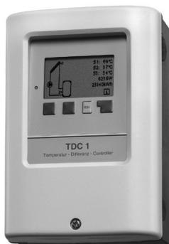
Mit dem „Temperatur-Differenz-Controller“ wird wasser-temperaturabhängig die Umwälzpumpe geregelt. So wird erreicht, dass die Umwälzpumpe nur läuft, wenn die Wassertemperatur im Kaminofen höher ist als im Pufferspeicher.
