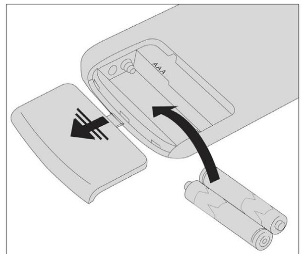
**WENN DIE FERNBEDIENUNG AUFGRUND DER ABWESENHEIT VON BATTERIEN AUSGESCHALTET IST, IST ES MÖGLICH, DEN OFEN ÜBER DAS BEDIENFELD IM OBEREN TEIL DES OFENS ZU STEUERN. BEIM AUSTAUSCHEN DER BATTERIEN IST DIE POLARITÄT ENTSPRECHEND DER SYMBOLE IM BATTERIEFACH DER FERNBEDIENUNG ZU BEACHTEN.**
